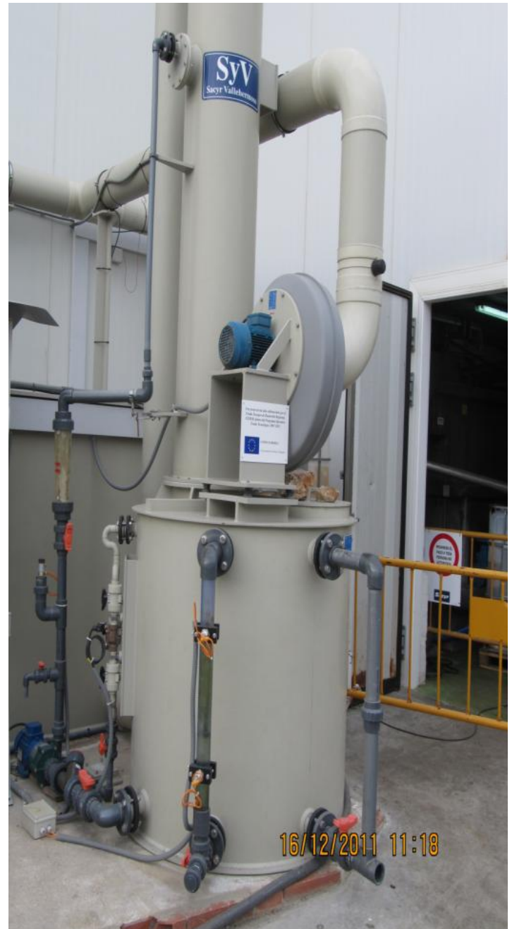
Figura. 5 Imagen del relleno del biofiltro y de la planta piloto completa
