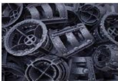
Figura. 3 Lecho de relleno de anillos. Sistema lavado de gases. Planta piloto lavado químico
