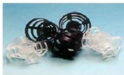
Figura. 3 Lecho de relleno de anillos. Sistema lavado de gases. Planta piloto lavado químico
