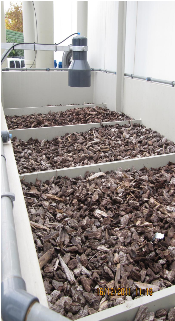
Figura. 5 Imagen del relleno del biofiltro y de la planta piloto completa
